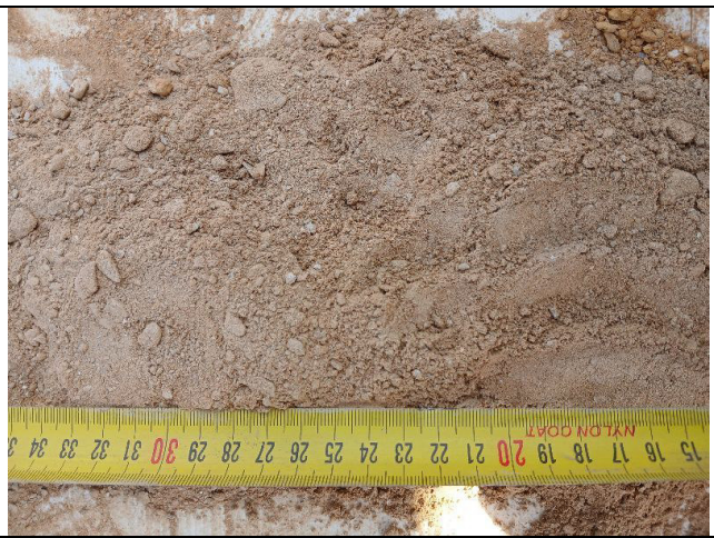
Sol : schistes altérés brun Tarière T3 : prélèvement de 1 à 2,2 m/TN
