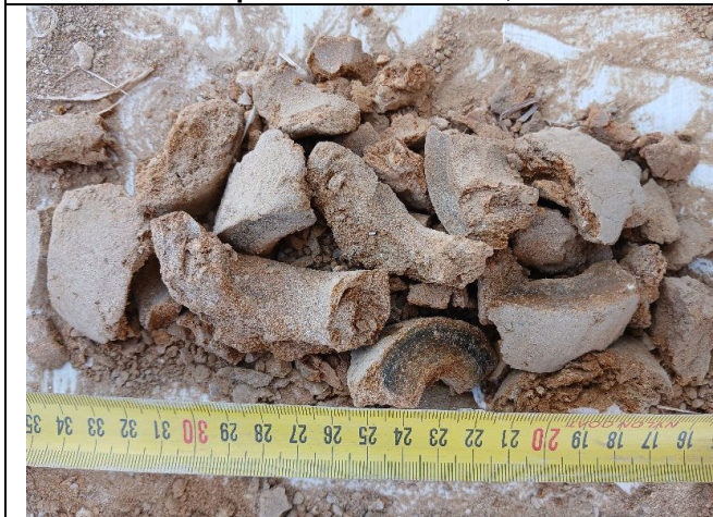
Sol : altérites d'aspect limono-argileux à graviers ocre Tarière T2 : prélèvement entre 0,6 et 1,1 m/TN
