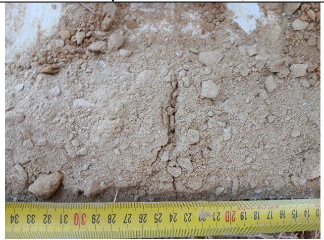
Sol : schistes altérés brun Tarière T2 : prélèvement de 1,1 à 1,6 m/TN
