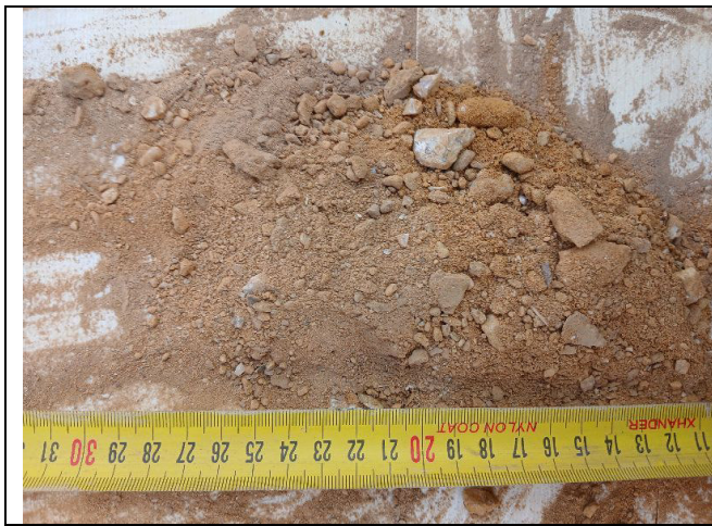
Sol : sable graveleux ocre Tarière T3 : prélèvement entre 0,4 et 1 m/TN
