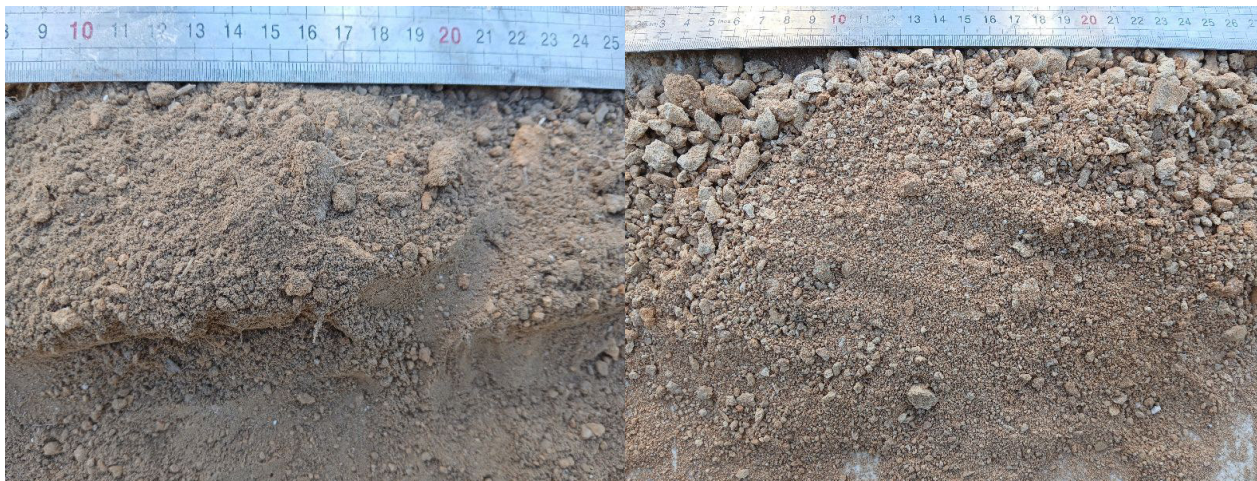
Sol : arène granitique (sablo-limoneux graveleux) beige orangé Tarière T1 : prélèvement entre 0,3 et 1,0 m/TN
