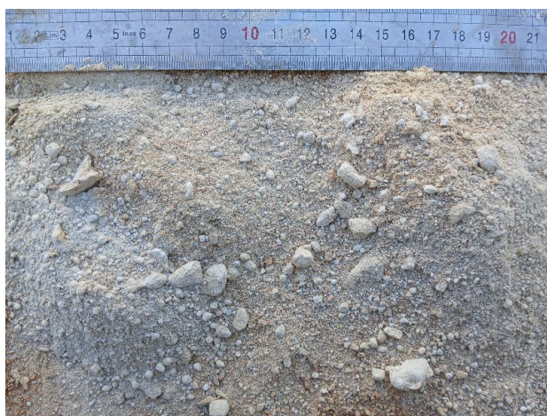
Sol : rocher +/- altéré (arène granitique à granite) beige blanc Tarière T2 : prélèvement entre 1,0 et 1,8 m/TN
