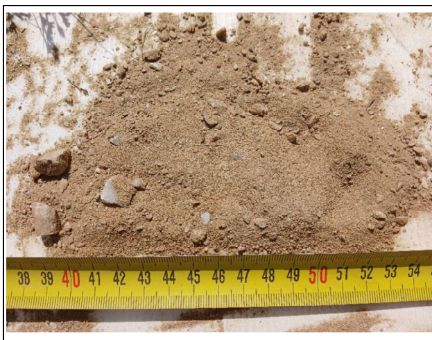
Sol : altérite de micaschiste (limon sablo-graveleux) à quartz Tarière T2 : prélèvement entre 0,1 et 0,7 m/TN
