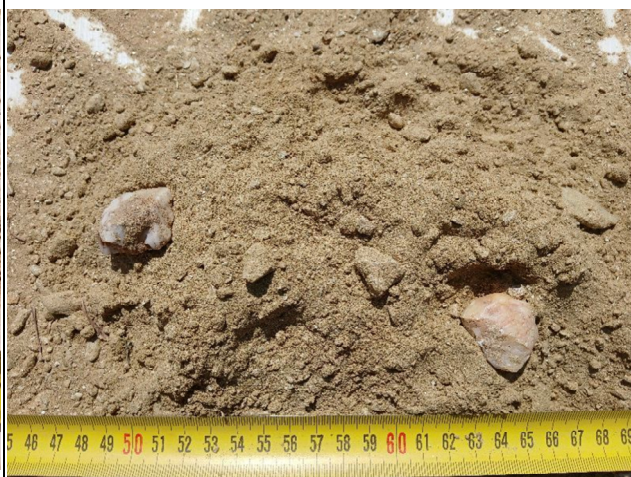
Sol : micaschiste +/- altéré ocre à brun Tarière T2 : prélèvement entre 0,7 et 1,8 m/TN
